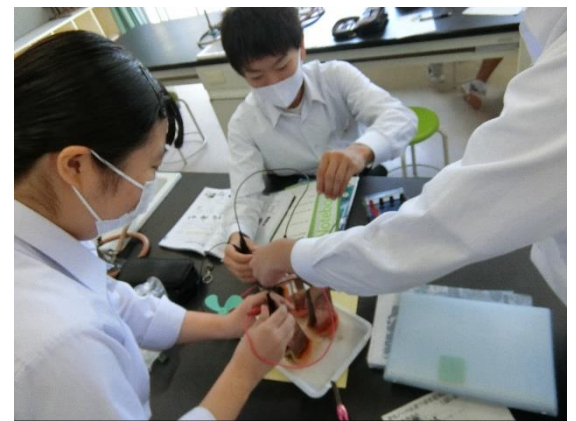
▲ iii) 果物でできるなら、野菜でもできるのではと考えたチーム。酸っぱいからという理由でトマトをチョイス。最強ではないが、微量の電流を検知。
