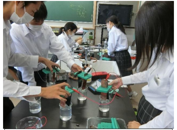
▲ iii) 食塩水は被膜をつくりやすく、電流は小さい。なので、直列回路でたくさんつなげ、電流量を増やそうとしています。協力して直列をつくっています。
