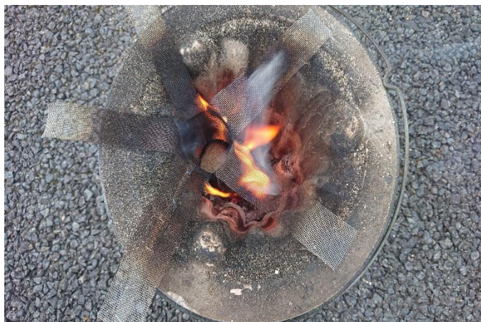
図. 10 金網で燃料の落ちる高さを調整したところ
