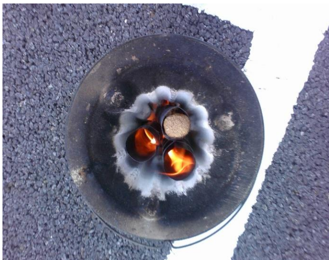
図. 11 2本の煙突で2次燃焼を促している
