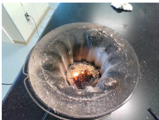
図.5 のりを混ぜてぼろぼろのとき燃え方
