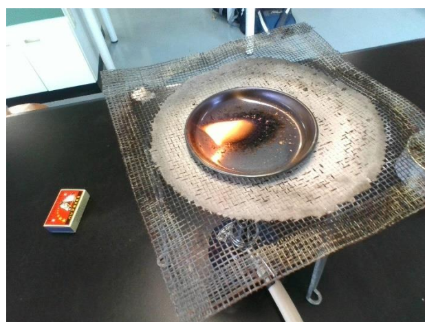
図.4 ガスバーナーで加熱すると燃え続ける
