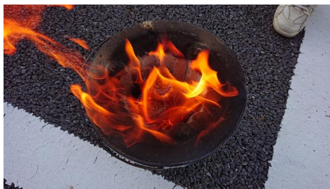
図. 1 3 3本の燃料筒では燃焼が継続する
