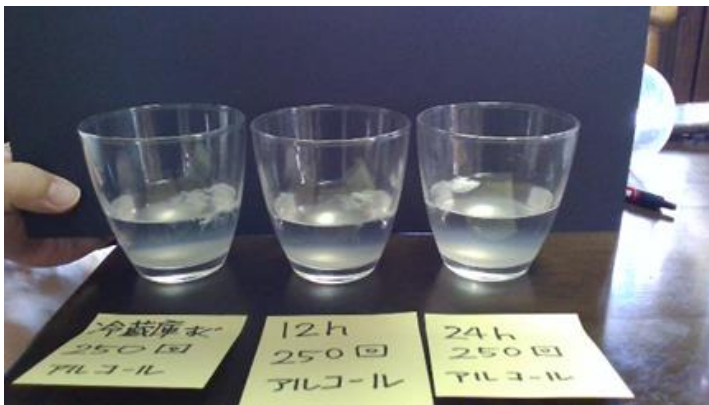
無水アルコールと反応して形成された傘状の塊(PGA)
