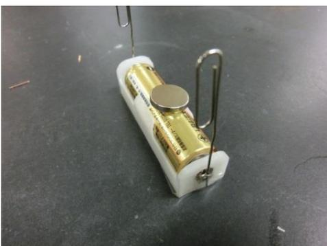
クリップは片側をのばし、電極に接するように電池ボックスに固定します。
