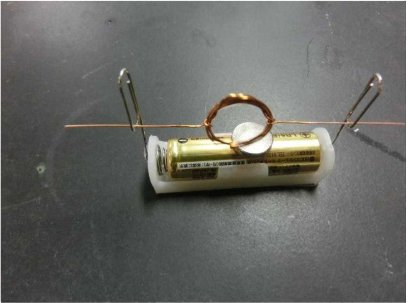
クリップモーターは、単純なモーターの仕組みを考えるに適した教材です。また、ネオジウム磁石が安価に手に入るようになったことで、反応もよく、動きもダイナミックなクリップモーターをつくることができるようになりました。
