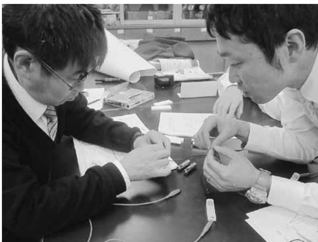
生活経験から、太い電熱線と細い電熱線ではどちらがより熱くなるかを予想させる。その上で、実験方法を選んで実験させる。教材として開発したのは2種類。1つは示温テープを短冊形に切ったものに太い電熱線と細い電熱線をのせ、温度変化の様子を確かめる。もう1つは発泡スチロールを切る時間を比較する。それらの実験で太い方が熱くなることを確かめられたら、さらに「なぜ太い方が早く熱くなったのか？」と問いかけ、探究的な学びを推進する。
