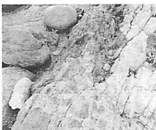
写真⑥ 水冷破碎岩と緑色に変色した部分
