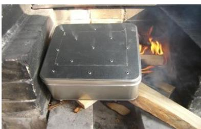
④ かまどに薪をくべて、火を着けます。火が大きくなったら缶を置きます。フタの穴から煙とガス(揮発分)が出て来ます。
